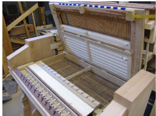
De registers zijn onder het klavier geplaatst en iedere tong heeft zijn eigen ventiel.
