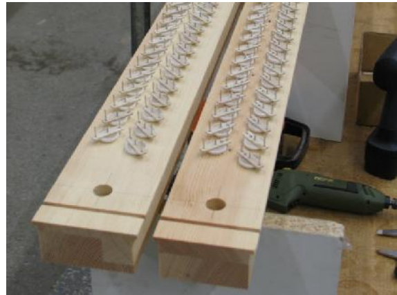
De kegels worden door de toetstructuur opgetild.
