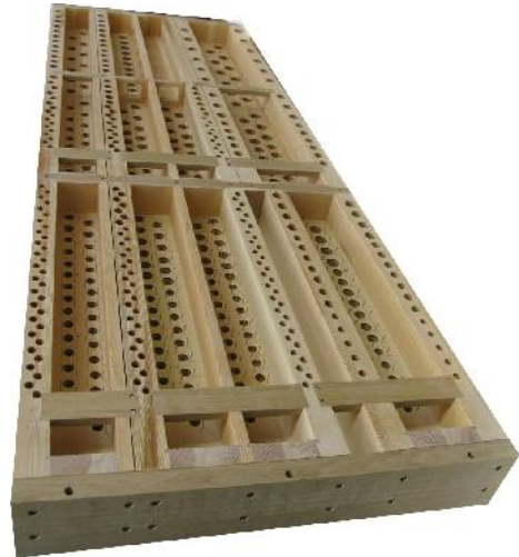
Als de registercancellen onder druk staan en de kegels worden opgelicht, wordt de lucht via verboringen naar de pijpen geleid. De kegels zijn verwijderd en de pijpenstokken zijn nog niet aanwezig.
